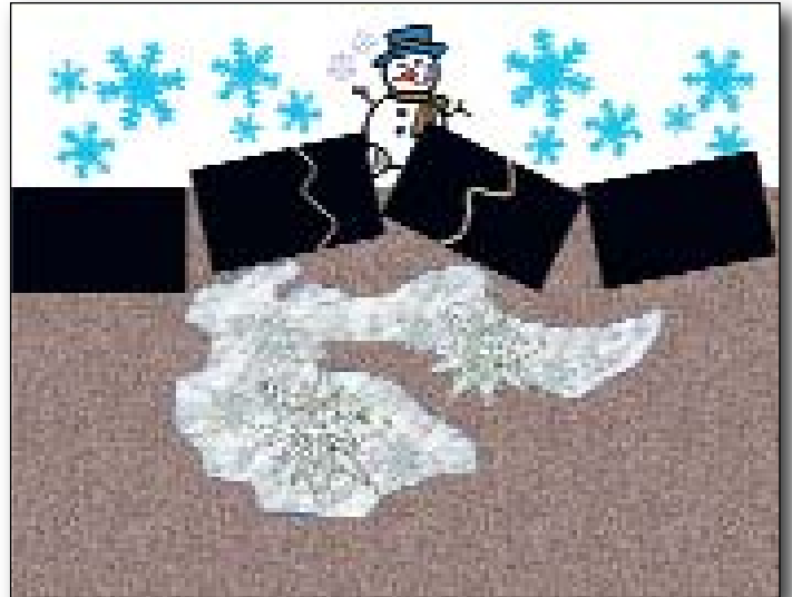
Çizim 6: Donan suyun buz olunca genişlemesi nedeniyle üzerindeki asfaltı kırması
